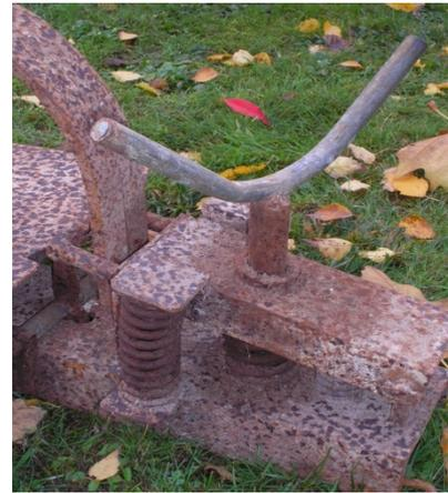
L'armement est assuré par une vis et 2 ressorts hélicoïdaux. Le poids total de l'engin est de 22 kg.
